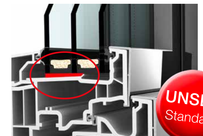
Rundum-Verklebung der Scheibe mit dem Rahmen aushebelsicher und formstabil
